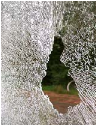
Afb.28 Thermisch voorgespannen glas: niet slagwerend
