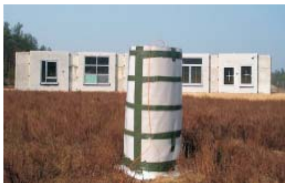
Afb.26 De testopstelling: 100kg TNT uitvoeringen, voor de gevel
